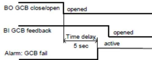
Cuando la salida Aper/Cier IntX se cierra hay 5 segundos de retardo para la detección de falla de IntX.
