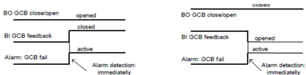
Cuando la salida Aper/Cier IntX se abre hay 5 segundos de retardo para la detección de falla de INTX.
