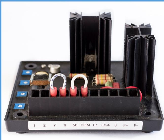
El mismo sensa la tensión promedio de salida del generador para mantener una precisión adecuada. Esto se logra convirtiendo la entrada monofásica en una señal de CC regulada comparada con una tensión de referencia interna, lo que nos permite tener un valor constante. Se puede obtener un ajuste preciso para las características independientes de cada generador utilizando los Trimmers de Estabilidad y Tensión.
